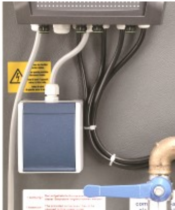
Abb. 6: Steckdose für Kompressor
